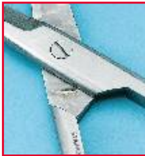
Wrijvingscorrosie door onvoldoende onderhoud met olie
