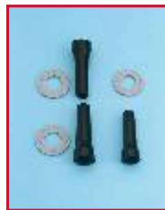
Rechts: Opgezwollen pakkingen ten gevolge van het niet-doelgericht aanbrengen van instrumentenolie. Links: Nieuwe pakkingen
