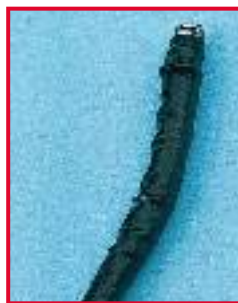
Opzwellen van een invoerslang door gebruik van een ongeschikt onderhoudsmiddel.
