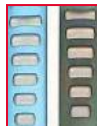
Fragment – titanium valves: Linker valve – fabrieksnieuw. Rechter valve – machinaal gereinigd. Meestal is de kleurverandering gelijkmatig. Deze kan echter ook vlekkelig/meerkleurig uitvallen.
