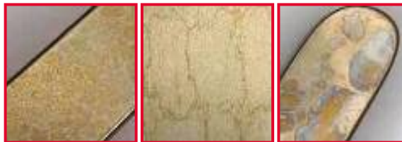
Typische silicaatverkleuringen op het oppervlak van de instrumenten na de stoomsterilisatie door een te hoog kiezelzuurgehalte in het gedemineraliseerd water.
