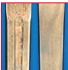
Verkleurde handgreepoppervlakken van scalpels
