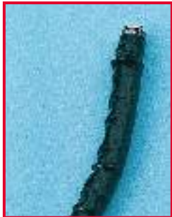
Opzwellling op het distaalluiteinde van een fiberscoop
