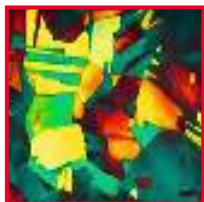
Kleuretsing - austenitische microstructuur roest- en zuurbestendig instrumentenstaal (500-voudige resolutie)
