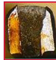
Detail: breuk van de bek van de klem met typische korrelvormige, interkristallijne breukstructuur.
