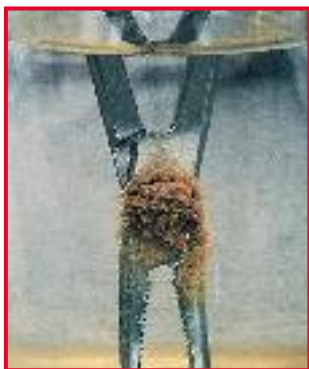
Roestvorming door enige uren onderdompeling in een fysiologische zoutoplossing
