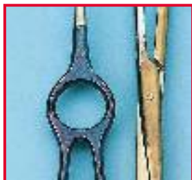
Verkleurde instrumenten door kiezelzuur
