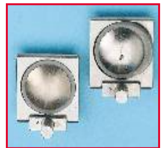
Rechts: Lekkend klepventiel van een trocar door opzwellen van de pakking ten gevolge van contact met olie. Links: Nieuw klepventiel
