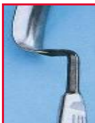
Wondhaak met zwart verkleurde schacht van gehard Cr-staal en blank geslepen handgreep en blad van CrNi-staal dat niet kan worden gehard
