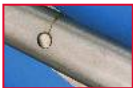
Haarscheurtje bij het scharnier van een schaar
