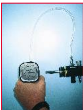
Handmatige controle op lekkage bij een flexibele endoscoop
