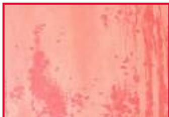
Al bij lichte alkaliteit zijn optische veranderingen bij geëloxeerd aluminium mogelijk
