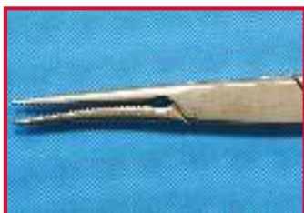
Vervorming door een ondeskundige behandeling
