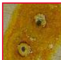
Chloridehoudend regenererzout veroorzaakt massieve aantasting door putcorrosie op het oppervlak van de instrumenten. Oorzaak: lekkende aansluiting van ionenwisselaar in de RDA.
