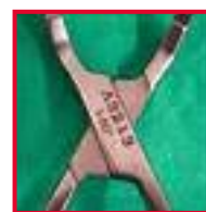
Schoon sluit-scharniergedeelte. Oorzaak: reiniging in geopende toestand.
