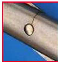
Detail: sluitscharnier schaar met typisch interkristallijn barstje.
